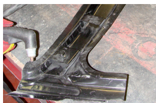
Facilidad de corte en chapas dobles y curvadas.
